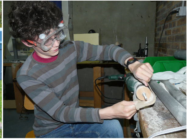
Réalisation de l'ogive et de la plaque de poussée
