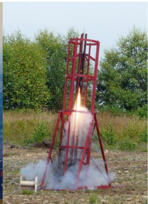
Sortie de Rampe (~20m/s)
