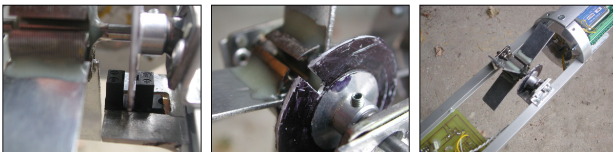
Le disque, les pâles ainsi que la fixation du capteur, sont autant d'éléments fait maison.
