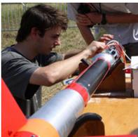
La **fusée expérimentale** a pour but d'embarquer des expériences comme par exemple une mesure de vitesse, d'accélération, d'altitude... Elle doit bien entendu également avoir un système de récupération par parachute comme la mini-fusée. La culmination sera d'environ 1500 mètres d'altitude pour une fusée de 7Kg.
